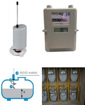
Sensores de Nivel de estanques y medidores para redes de distribución de Gas licuado (con baterías de duración superior a 10 años, considerando 2 mensajes por día).
