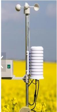
Estación meteorológica y sensor de suelo.
