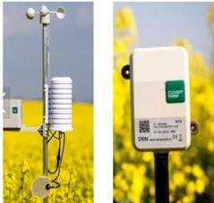
Estación meteorológica y sensor de suelo.
